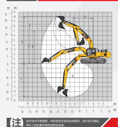
性能参数 标准 SY225C 整机重量kg 22300 斗容m<sup>3</sup> 0.83-1.0(1.0) 额定功率kW/rpm 118/2000 行走速度(高/低)km/h 5.4/3.3 回转速度rpm 11 爬坡能力 70%/35° 接地比压kPa 47.4 铲斗挖掘力kN 138 斗杆挖掘力kN 103
